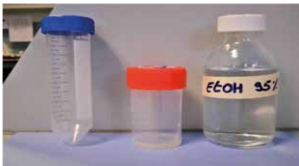
Figure 2.4 Tube Falcon® + 1 volume de crachat + 2 volumes d'éthanol à 95°
